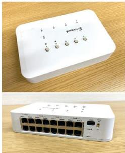
AbcCoreを最大4台搭載してモータ8台の制御が可能な制御BOX
